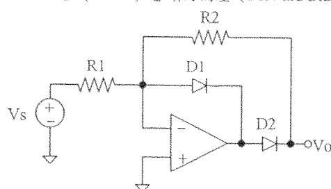
6. 如以下電路圖所示。所有電晶體  $\beta_F$  是無限大， $V_{BE(on)}=0.7\text{V}$ 。請算出  $V_o$  的電壓值(V)。
