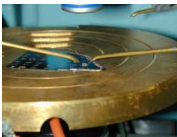
圖九 利用探針台來做電性的量測
